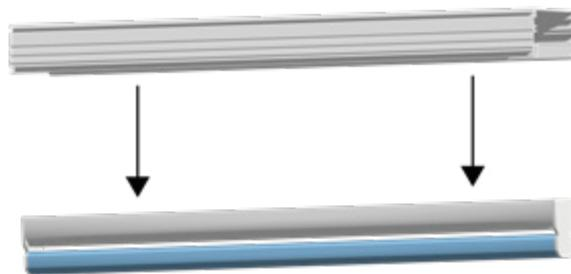
Die energiehungrige Leuchtstoffröhrenlampe wird abmontiert und mit dem intelligenten Beleuchtungssystem TRIVALITE modernisiert. Die LED-Beleuchtung wird mit der passenden Universalbefestigung an das bestehende Schienensystem eingepasst.
